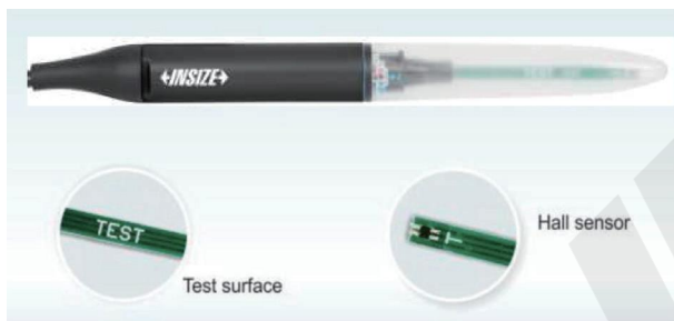
Fig 3.9 Schéma de la sonde à effet Hall radiale
