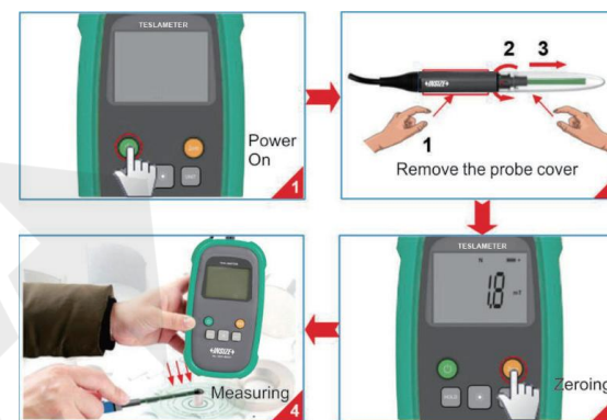
Fig 3.4 Schéma des étapes de mesure de base
